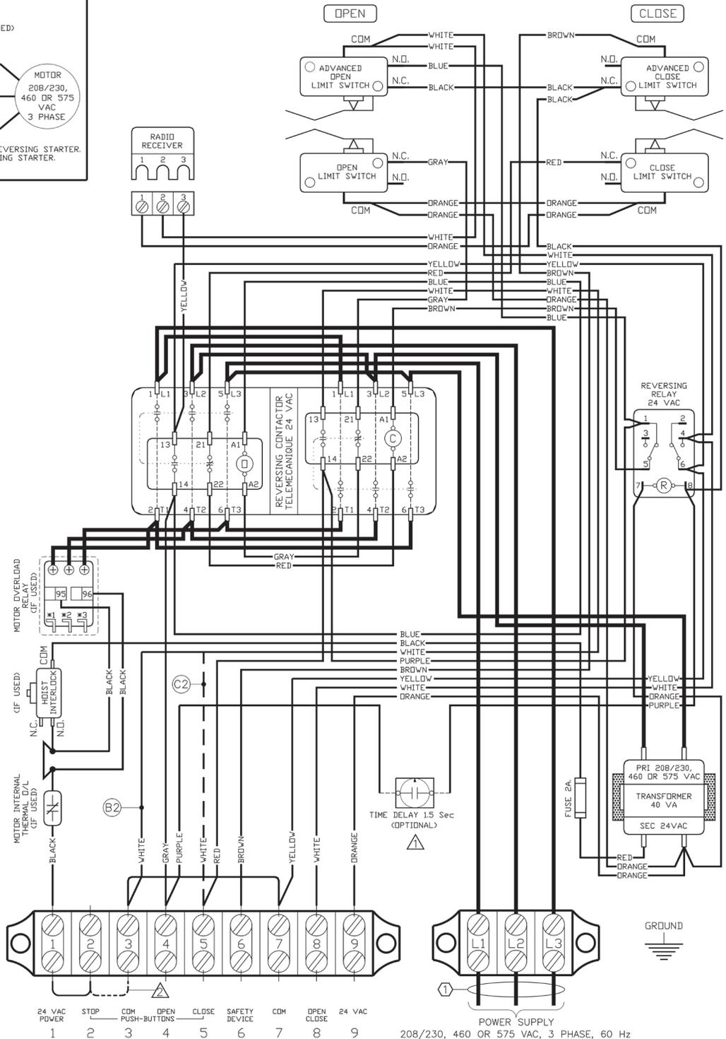
3-Phase Wiring Diagram
